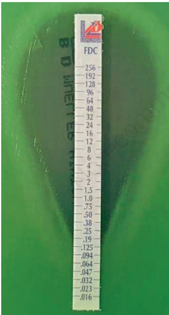
Figura 2. Esempio di test a gradiente (vedi testo). MTS™ per cefiderocol su ceppo di Pseudomonas aeruginosa . Minimal inhibitory concentration (MIC) pari a 0.25 µg/ml.
